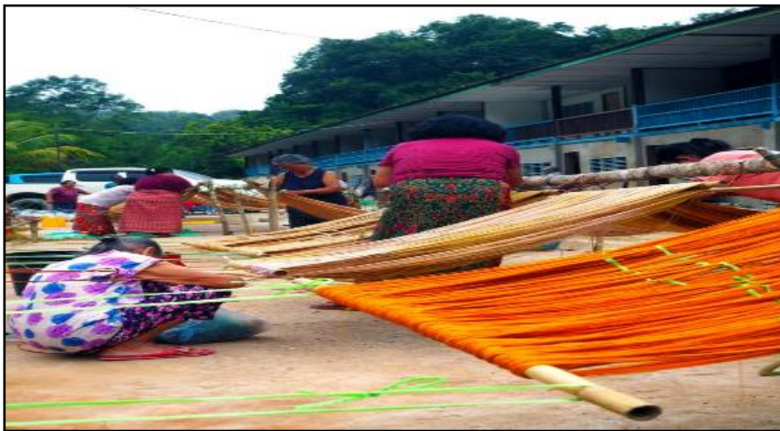
Foto 1.9: Proses mengantung benang taya yang telah direndam dalam dulang takar di atas tanju
